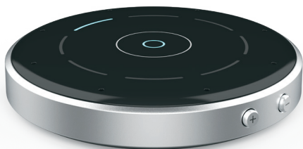
Figure 1. Microphone de table de table en mode Automatique. Le segment illuminé indique la direction dans laquelle la formation de faisceaux est active.
